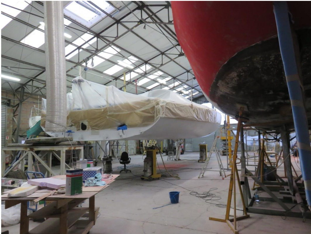
A gauche, un IMOCA en cours de ponçage
