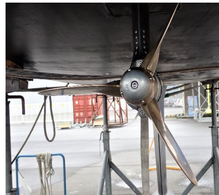
Sous voile, mise en drapeau → trainée minimale
