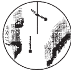
(b) Sillages des cibles en mode relatif (Déplacements relatifs des cibles par rapport au bateau)
