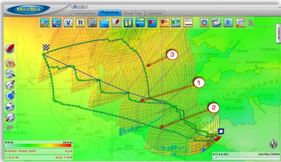
Calcul de la route optimale en laissant les waypoints à Bâbord: (3) - Laisse à Bâbord
