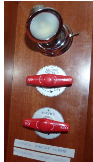
Poignées horizontales circuit ouvert : Le courant ne passe pas
